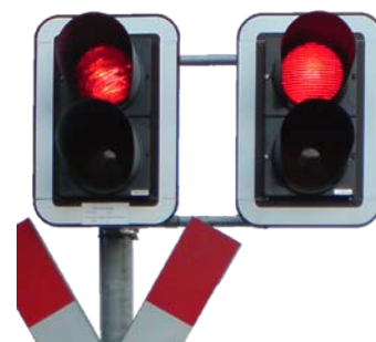
Der Vergleich: links - Glühfaden rechts - LED
